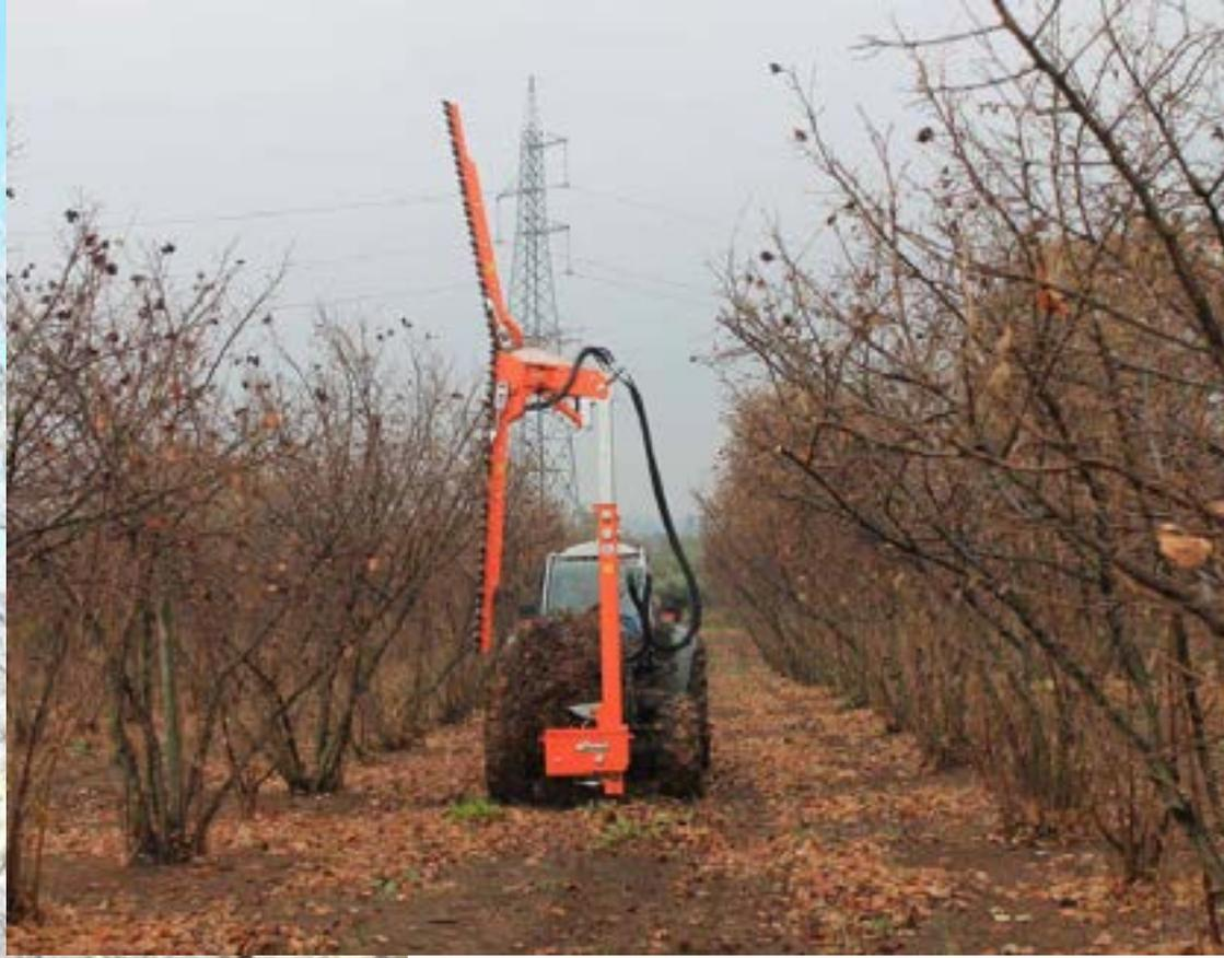
**Particolare di barra a dischi rotanti (a) e barra a denti tipo cimatrice da vigneto (b) applicate in impianti adulti nel viterbese.**
