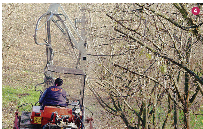
1 Un ramo infestato dalla Cytospora corylicola , detta mal dello stacco; 2 apice di un nocciolo disseccato per effetto del fungo; 3 nocciolo potato meccanicamente; 4 la potatura con l'utilizzo di dischi idraulici.
